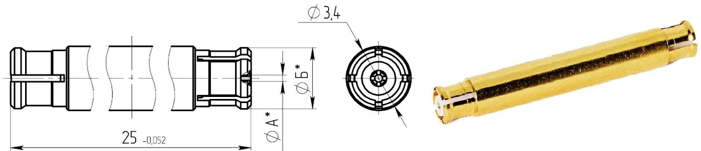
\* Размеры А и В обеспечивают врубное соединение с ответным соединителем. Соединитель условно показан в рабочем (деформированном) состоянии.
