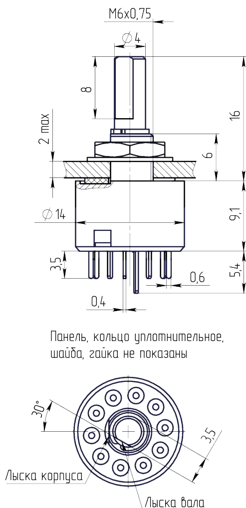
Габаритные и установочные размеры
