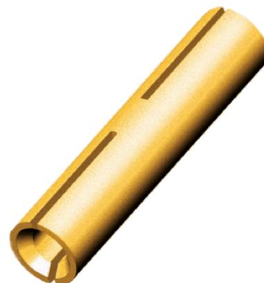
\* Размер А обеспечивает усилие расчленения с контрольным штырём  $\phi 0,495_{-0,002}$  не менее 0,020 кгс, не более 0,100 кгс.
