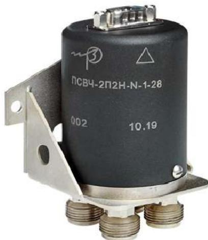
Электромеханический коаксиальный переключатель ПСВЧ-2П2Н-Н-1-28 предназначен для замыкания, прерывания или изменения пути прохождения сигналов в диапазоне частот от 0,01 до 12,4 ГГц в коаксиальных трактах с волновым сопротивлением 50 Ом и с режимом холодного переключения (отсутствие сигнала до начала изменения положения контактов).
